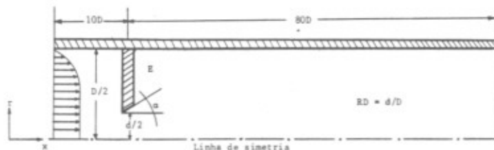
Fig. 2.1 - Domínio de solução utilizado na metodologia numérica.
