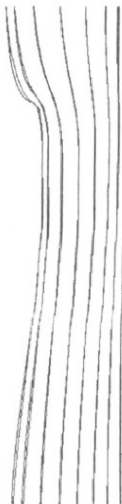
Figura 5 - Zoom, malha com geração elíptica ao longo do escoamento.
