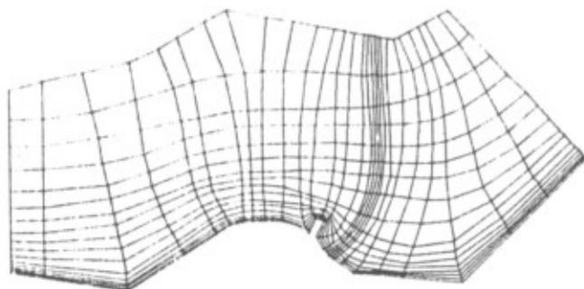
Figura 4 - Discretização de uma geometria arbitrária
