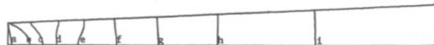
Figura 7. Isobáricas ( p/p_\infty ) para M_\infty = 2.0 , \alpha = 2.5^\circ , \epsilon = 3.51 , r_1 = 0.05 m e L = 1.0 m (caso 6).
